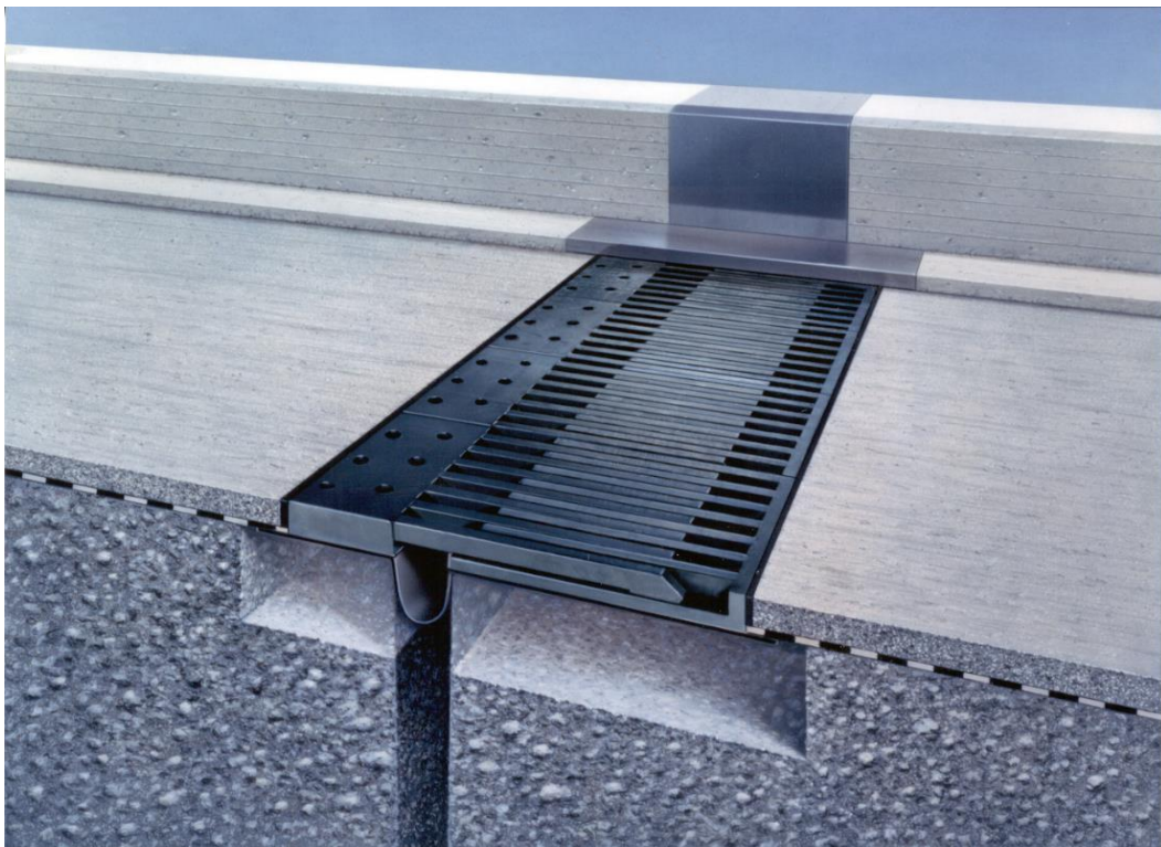
Fig. 5.1 Joint de chaussée à peigne appuyé.
